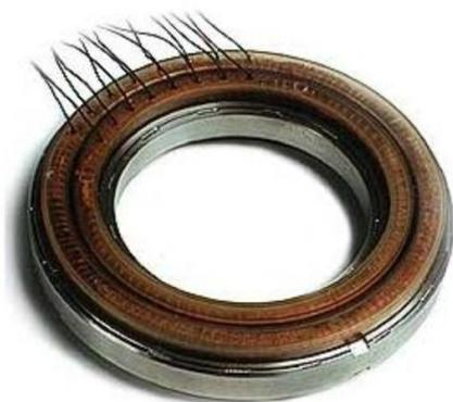
Вращающиеся трансформаторы ВТ100 предназначены для работы в режиме трансформаторной дистанционной передачи и в качестве первичного датчика в цифровых преобразователях «Угол-Код». ВТ100 выполнены в виде отдельных узлов статора и ротора, монтируемых непосредственно в посадочных местах аппаратуры. Датчики имеют каналы точного отсчета (ТО) и грубого отсчета (ГО). Выводы обмоток ТО и ГО выполнены гибкими проводниками.
