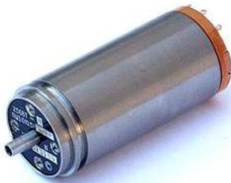
Бесконтактные вращающиеся трансформаторы 2,5БВТ предназначены для работы в электромеханических счетно-решающих устройствах, следящих системах, а также в качестве первичного датчика в цифровых преобразователях «Угол-Код». В бесконтактных вращающихся трансформаторах токосъем осуществляется с помощью кольцевых трансформаторов, что обеспечивает высокую надежность изделий.
