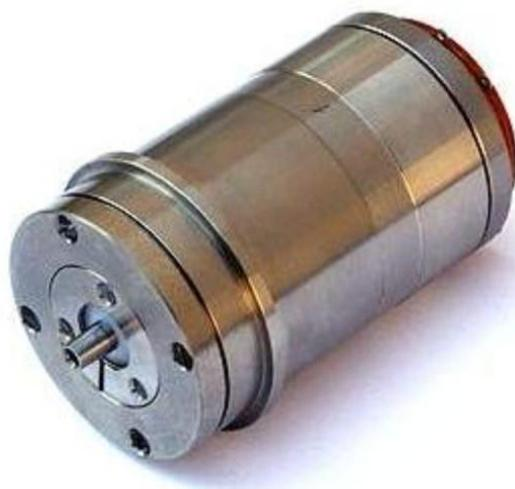
Бесконтактные вращающиеся трансформаторы 5БВТ предназначены для работы в электромеханических счетно-решающих устройствах, следящих системах, а также в качестве первичного датчика угла в цифровых преобразователях «Угол-Код». Съем сигнала в 5БВТ осуществляется с помощью кольцевых трансформаторов, что обеспечивает высокую надежность изделий.
