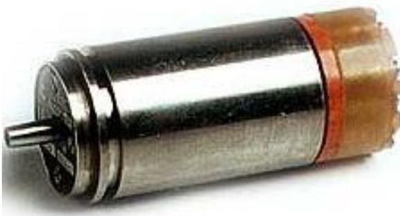
Вращающиеся трансформаторы 2,5ВТ предназначены для работы в электромеханических счетно-решающих устройствах, следящих системах, а также в качестве первичного датчика угла в цифровых преобразователях «Угол-Код». Съем сигнала в 2,5ВТ осуществляется через контактные кольца.
